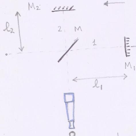
El tiempo  $t_1$  medido para el observador  $O$  fijo a tierra (fijo al interferómetro) para que el rayo de luz vaya de  $M$  a  $M_1$  y de vuelta a  $M$  es
