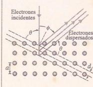
Podemos demostrar que el máximo corresponde al primer orden de difracción, m = 1 (ver el problema siguiente). Sustituyendo en la ley de Bragg, se obtiene una longitud de onda:
