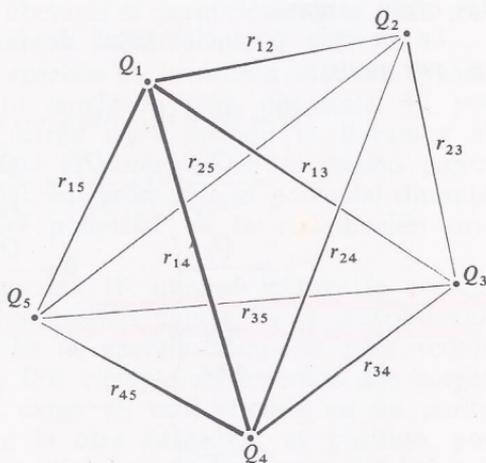
**Figura 2.14** Conjunto de cargas puntuales  $Q_1, Q_2, \dots, Q_5$  separadas por las distancias  $r_{12}, \dots, r_{45}$ .
